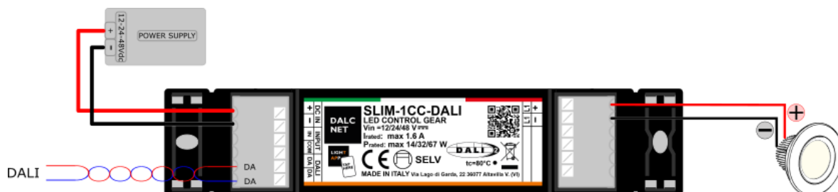
Figura 2: Schema di collegamento per carichi LED bianchi o monocoloro
